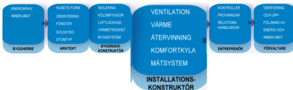
Figur 4.6 Installationskonstruktörens roll i en energiriktig projektering
